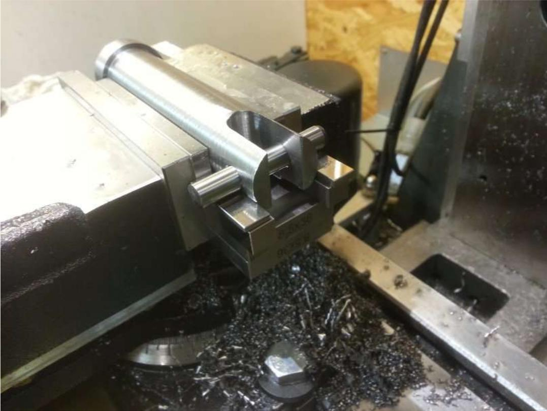
Bei der Einfräsung der Nut und dem Bohren der verschiedenen Bohrungen ist es von Vorteil, wenn man Parallelstücke und/oder Endmaße zur Verfügung hat. Leider passte die Druckspindel nicht ins Futter meines Teilkopfes.
