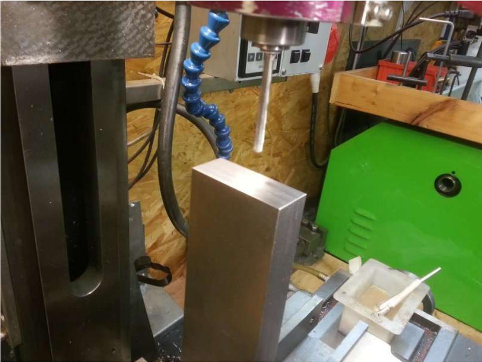
Bohren der Bohrung an der Schmalseite. Wegen der maximalen Höhe der BF20 wurde der Bohrer mit einer kleinen Hülse in einer Direktspannzange eingespannt.
