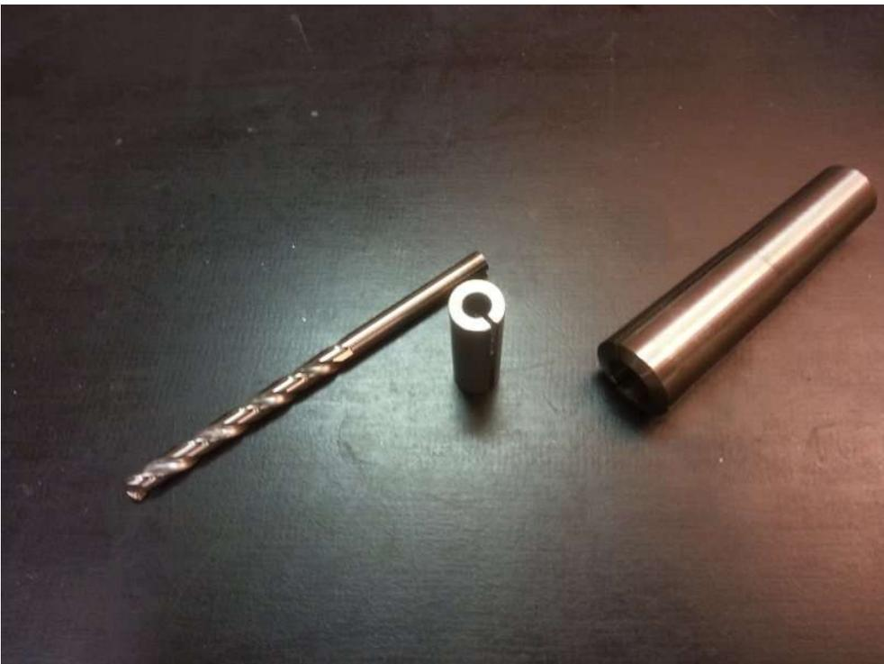
Bohrer  $\varnothing 5$  mit Adapterhülse für  $\varnothing 10$ mm Direktspannzange
